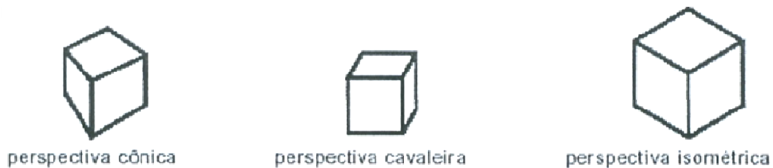
Figura 48 – Representação de um cubo em três tipos de perspectiva
